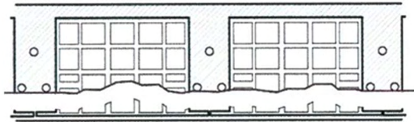
Figura 1 - Sezione tipo solaio laterocemento soggetto a sfondellamento
